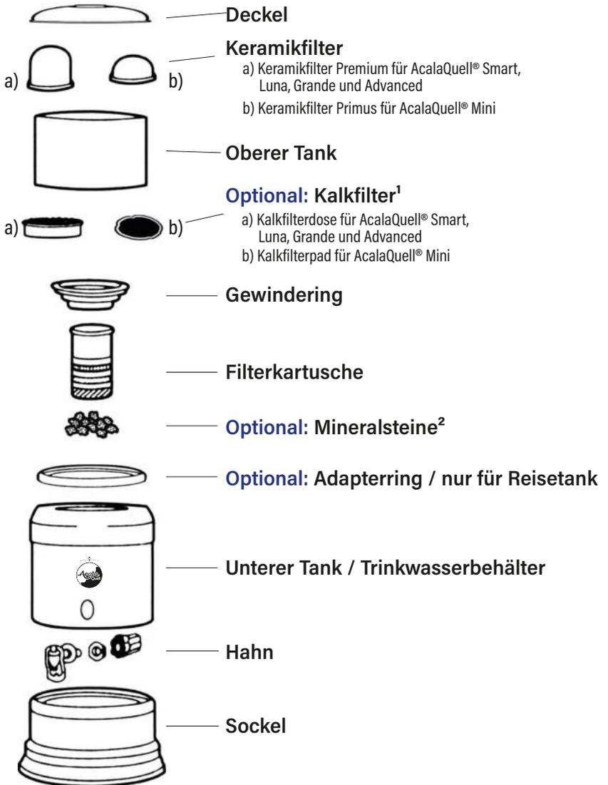
1) Bei dem Modell AcalaQuell® Advanced ist der Kalkfilter immer einzusetzen.
