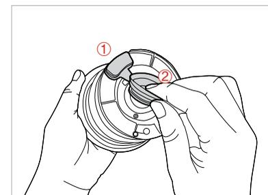
Die Silikonflügel lassen sich bei Bedarf zur Reinigung abnehmen. Nach der Reinigung bauen Sie die Silikonflügel wie in der Abbildung gezeigt wieder in den Rotationswischer ein.
