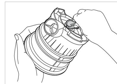
Die Silikondichtung lässt sich zur Reinigung abnehmen. Setzen Sie die Dichtung wie auf dem Bild gezeigt wieder ein, achten Sie dabei auf korrekten Sitz.
