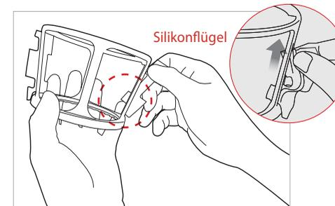
**TIPP** | Setzen Sie den Silikonflügel ein, ausgerichtet mit dem kurzen Ende nach unten.
