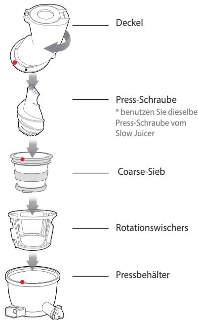
**2** Setzen Sie den Aufsatz auf den Motorsockel.
