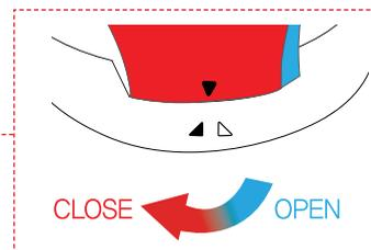
Richten Sie die Pfeilmarkierung ▼ auf dem Deckel an der △ Open-Markierung des Motorblocks aus und drehen Sie den Entsaftungs-Aufsatz im Uhrzeiger-Sinn bis die Pfeilmarkierung des Deckels mit der ▲ Close-Markierung übereinstimmt.
