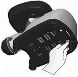
Dieses Produkt besitzt einen Reset-Schalter und einen Überhitzungsschutz, um das Gerät zu schützen. Wenn der Motor während des Betriebs stoppt, drücken Sie den Reset-Schalter an der Unterseite des Geräts. Wenn das Gerät weiterhin nicht funktioniert, ziehen Sie den Netzstecker, lassen Sie es 30 Minuten abkühlen und versuchen Sie es erneut.
